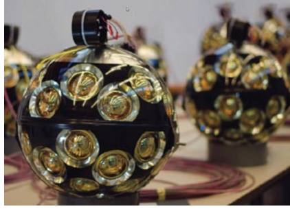
Laboratuvar ortamında fotoçoğaltıcı tüpler
