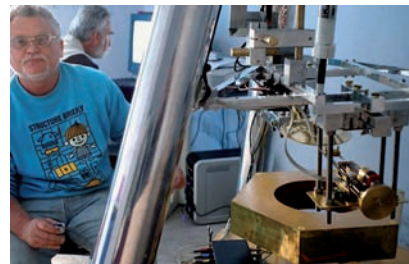
Şekil 11. Manavgat Meslek Yüksek Okulu'nda mikroravite değişimi deneyinde kullanılan hassas sarkaç sistemi ve geliştiren amatör fizikçi Thomas Goodey.
