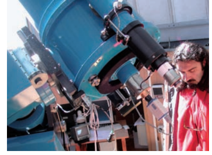
Şekil 4. TUG'un 40 cm ayna çaplı emektar T40 teleskobu ilk defa bir TGT için hazırlanıyor.
