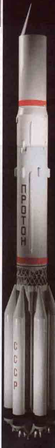
Spektrum X-Gama uydusunu yörüngeye oturtacak olan Proton roketi (1/25 modelden) 44 metre uzunluğunda ve 647 ton ağırlığındaki roket 1965 ten beri kullanılıyor.
