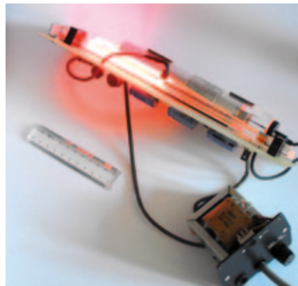
1977'den bu yana çalışan bir HeNe lazeri. Sağda, yüksek gerilim trafosu. Işıldama yapan gaz tüpünün iki ucunda çınlanım kovucunu oluşturan aynalar var. Çıkış gücü 1mW'dan küçüktür.
