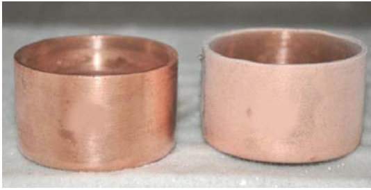
Sıcak ve soğuk su örneklerinin bulunduğu kaplar buzluğa yerleştirildiğinde -eğer kapların tabanları yalıtkan bir malzeme ile kaplı değilse- sıcak su örneğinin bulunduğu kap altında kalan buzun erimesine sebep olur. Eriyen buz bir süre sonra tekrar donar ve bu durum ısı iletkenliğinin artmasına neden olur.
