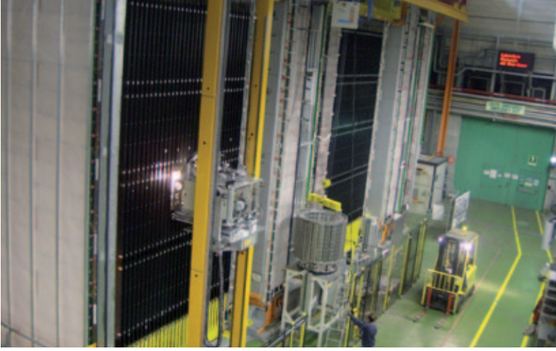
Gran Sasso yeraltı laboratuvarına yerleştirilen OPERA adlı algılayıcı. 10 metre yüksekliğinde ve 20 metre uzunluğundaki OPERA algılayıcısı 4000 ton ağırlığında.
