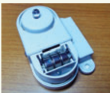
Şekil 17: Mıknatıs yakında iken LED sönmüş
