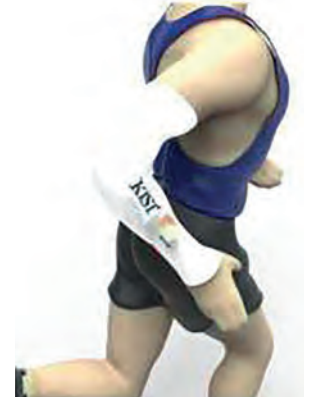
Esnek batarya, üç boyutlu yazıcı teknolojisiyle doğrudan esnek bir kumaşın üzerine de yazdırılabiliyor.
