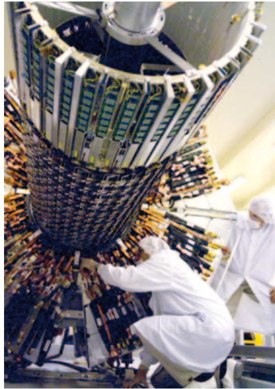
ATLAS'ın silikon dedektörlerden yapılmış iç dedektörü bir soğan kabuğu gibi. Burada dördüncü kabuğun dıştaki kabukların içine yerleştirilme aşaması görülüyor.
