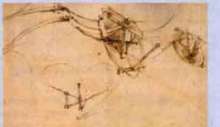
Kayıp biçimli bir gövdesi de olan kürekli bir ornitopterin eskizi ve sonradan yapılmış kısmi modeli. Araca, yön ve yükseklik kontrolü sağlamak için kuyruk da eklenmiş. Günümüzdeki ornitopter tasarımlarında da, buradakinine benzer biçimde, kürek çekme hareketiyle uçuş ön planda.
