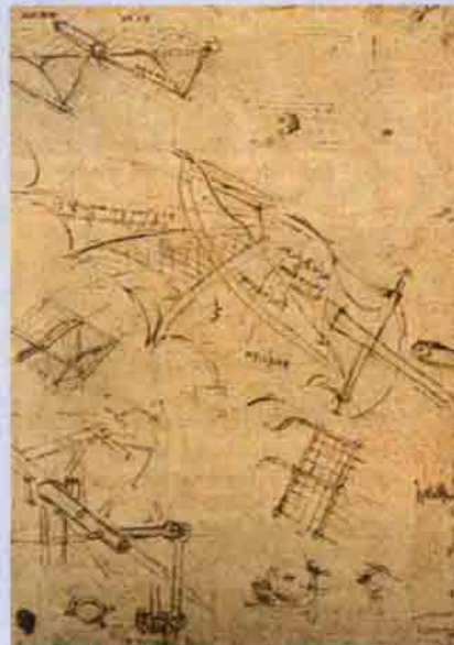
Bunlar büyük olasılıkla Leonardo'nun ilk kanat tasarımları. Hatalı olarak, kuşların kanatlarını yukarı çekişleri sırasında, tüylerin arasından hava geçtiğini düşünmüştü. Bundan yola çıkarak, kanatlarının yüzeyini, tek yönde açılır küçük kağıt kapakçıklarla dolu olarak tasarlanmıştır.
