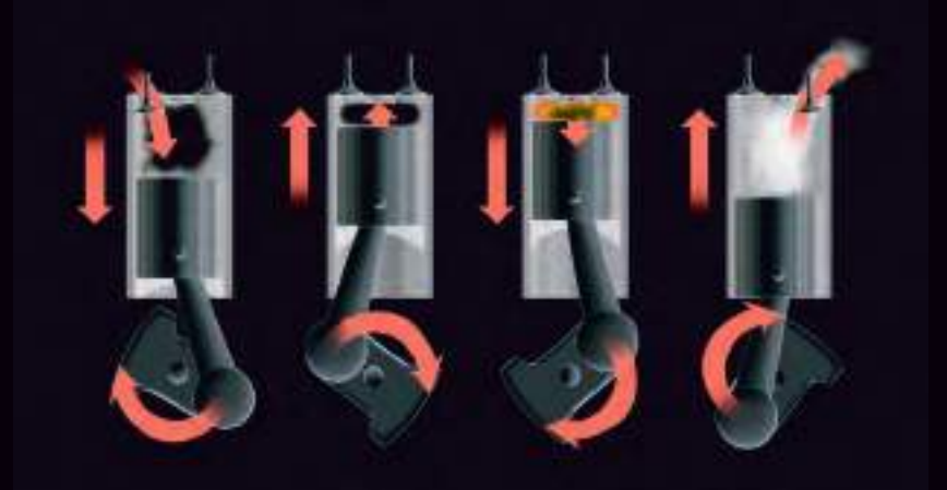
Dört zamanlı bir dizel motorun çalışma aşamaları: yakıt girişi, sıkıştırma, ateşleme, genişleme.
