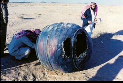
21 Ocak 2001'de uzayaya fırlatılan bir Delta-2 roketinin kademelerinden biri atmosfere girdikten sonra yere kadar ulaştı. Yaklaşık 70 kg'lık bu enkaz, Suudi Arabistan'da bulundu.
