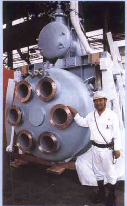
Geminin jet teşkilatı: MDH motorlarının her biri 6 tane jet borusuna sahip; borulardan ışıktırılan su ışıması demetleri sayesinde gemiyi harekete geçirecek bir itme gücü oluşturuyor.
