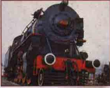
Lokomotif No. : 45174 Üretici Firma : Amerikan Loco-Co Hizmet Dönemi : 1943-1987 Kazan Gücü (BG) : 1616 Azami Hız (Km/Saat) : 70
