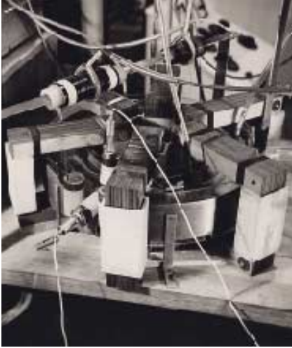
Üstte, İstanbul Üniversitesinde 1960-1965 yılları arasında geliştirilen birinci tokamak makinesi (hızlı dinamik sıkıştırımlı tokamak). Sağda, 1980'lerde geliştirilen birinci Spheromak.
