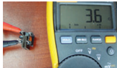
Şekil 15 Düşük değerli direnç ölçümü
