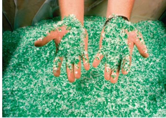
Eritme aşamasından önce yıkanmış ve temizlenmiş plastik atıklar
