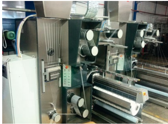
İplik üretim makinesinde sündürülerek dayanıklılığı ayarlanan iplikler
