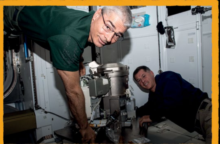
Mühendisler istasyon için geliştirilen yeni tuvalet sisteminin kurulumunu yapıyor.
