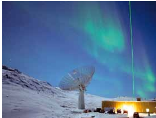
Kuzey Kutbu'ndaki istasyondan stratosferdeki bulutları gözlemleyen ARCLITE LİDAR sistemi Kaynak: http://isr.sri.com/instruments/data/arclite/greenbeam_lg.jpg
