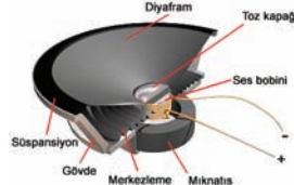
Şekil 3 Hoparlörün iç yapısı
