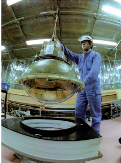
Süper-Kamiokande detektöründe kullanılan foto çoğaltıcı tüp. Bu tüplerden yaklaşık 12.000 adet üretilip detektöre yerleştirildi.
