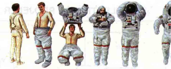
ABD uzay mekiğinde yarı-katı skafandrlar kullanılmaktadır; gövde katı, kol, bacak ve eklemeler hareketlidir.
