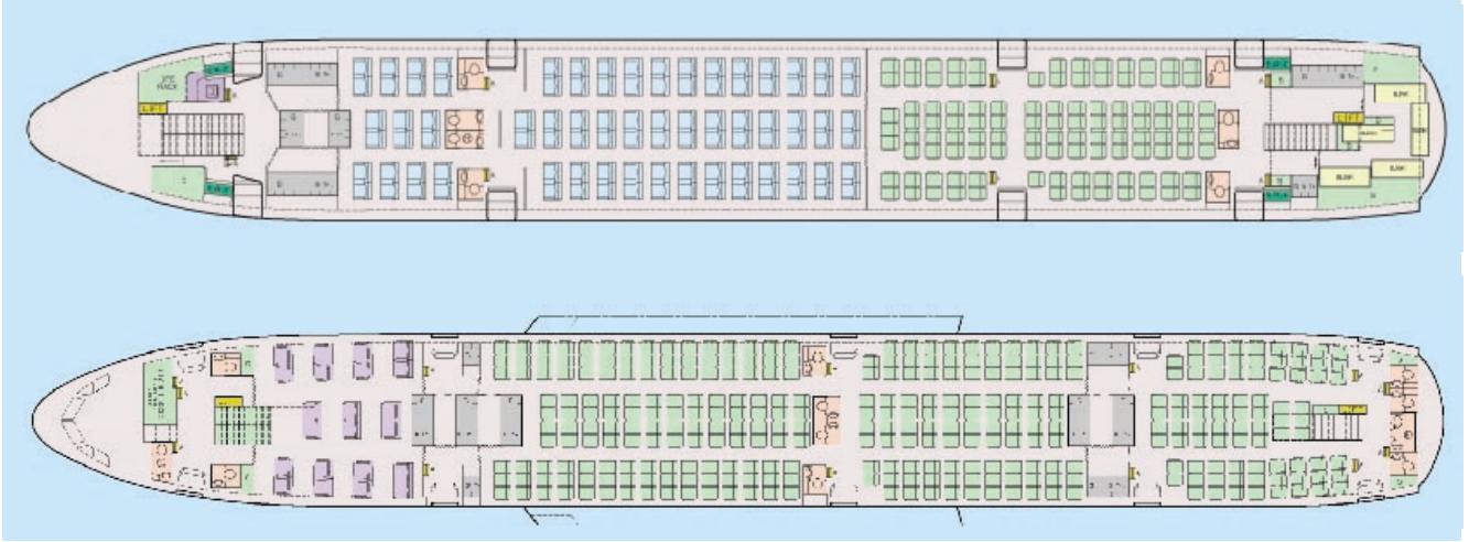
Airbus A3XX-100'ün yolcu kabinlerine ait yerleşim planı. Üstteki plan üst, alttaki plan alt kata ait. Yeşil kodlu koltuklar Ekonomi, maviler Business ve morlar Birinci Sınıf yolculara ait yerleri işaretliyor. 431 Ekonomi, 102 Business ve 22 Birinci Sınıf koltuk var.
