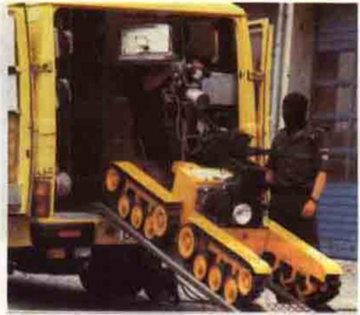
GSG 9 uzmanları, şüpheli maddeleri bir su salvoşuile açıyorlar (örneğin bir bomba böylece etkisiz hale getiriliyor). Bu işi yapan mini tank uzak-tan kumanda ve kontrol ediliyor.
