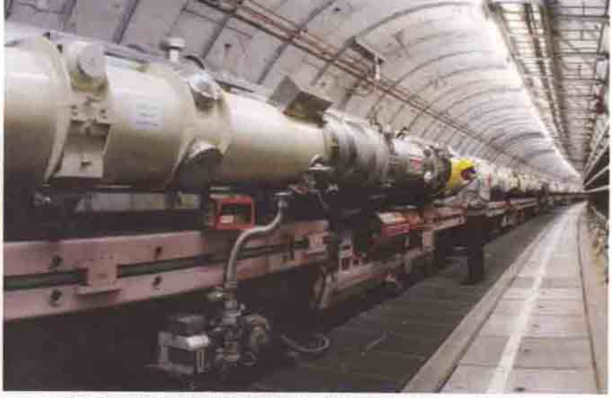
Çevresi 6,3 km tutan HERA tünelinin içinden bir görüntü. Süperiletken mıknatısların yönlendirdiği proton halkası üstte, daha alışılmış elektron halkası ise altta görülmektedir. Çok farklı iki tür parçacıktan oluşan iki demetin 4 çarpışma noktasında yeterince yüksek frekanslarla çarpıştırılması, HERA işleticilerinin büyük hüneleridir.
