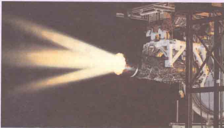
AVEN projesiyle geliştirilen F110 motorunun açısının değiştirilerek test edilmesi. Uzun süre pozlanan fotoğrafta motorun hareketi görülebilir.
