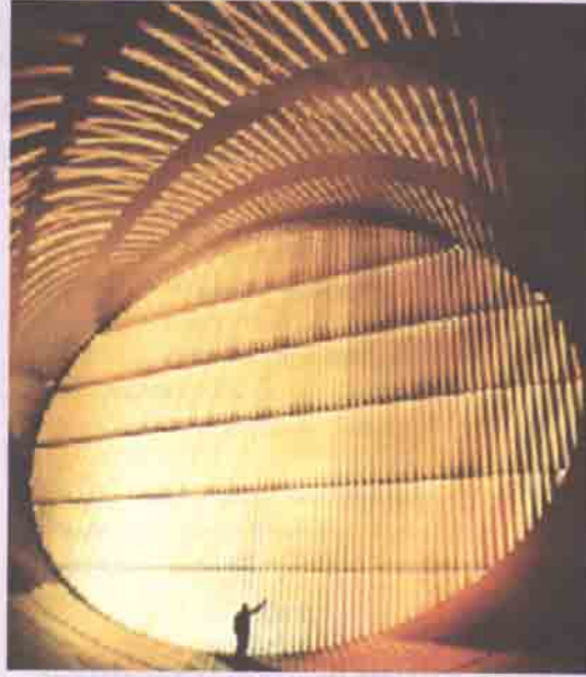
Langley Araştırma Merkezi'ndeki, motorların test edildiği hava tüneli
