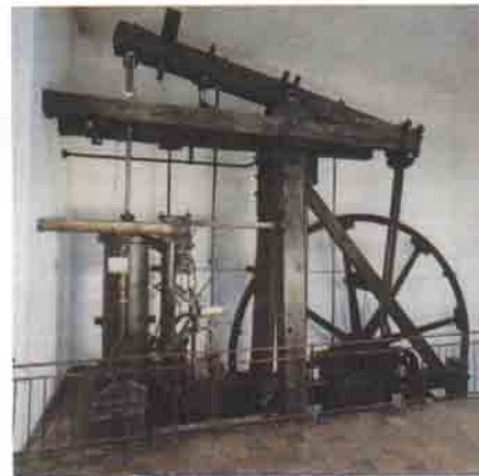
Daha az kömür kullanıldığı için daha verimli olan endüstriyel bir buhar makinesi. Sağda, Watt’ın yaptığı ilk buhar makinesi.
