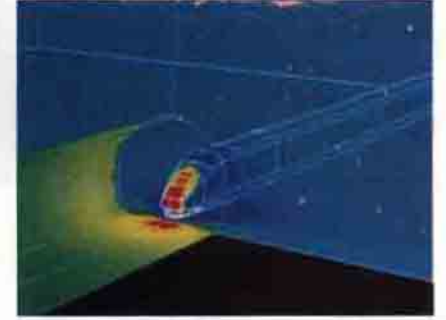
Tren tünele girdiğinde, yolcuların kulaklarında uğultuya neden olan basınç dalgaları, tünel boyunca trenle birlikte ilerler ve geri döner. Bazı dalgalar bilgisayar simülasyonu ile ölçülebilir; kırmızı renk en yüksek basıncı gösterirken, onu yeşil ve sarı izler. Simülasyon sonuçları, trenlerin burun kısmının uzun olmasının basınç dalgalarını azaltıcı bir etki yaptığını gösterir.
