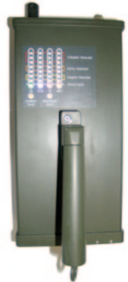
TÜBİTAK MAM'da geliştirilen elektronik burun sistemi
