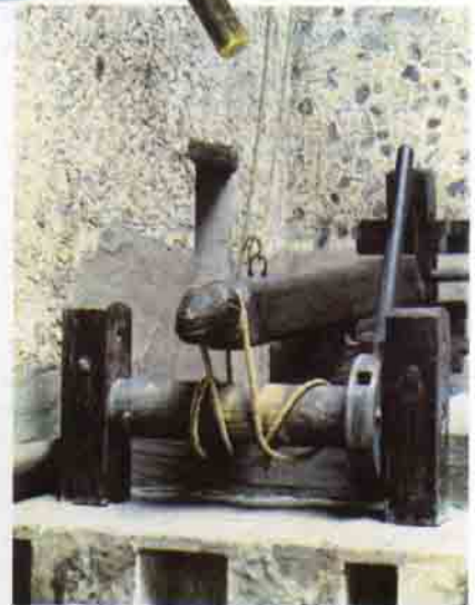
Pompeii'de bulunan kalıntılardan esinlenerek yapılmış kaldıraç tipi şarap ve zeytinyağı presi.
