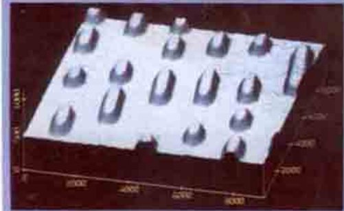
STM'nin endüstriyel uygulamalarına birkaç örnek: En üstte, bir dağıtma ızgarasının altın kalıbı gösteriliyor. Ortadaki resim bir manyetik kayıt kafasına ait. En alttaki ise bir kompakt diskin yüzeyini gösteriyor.
