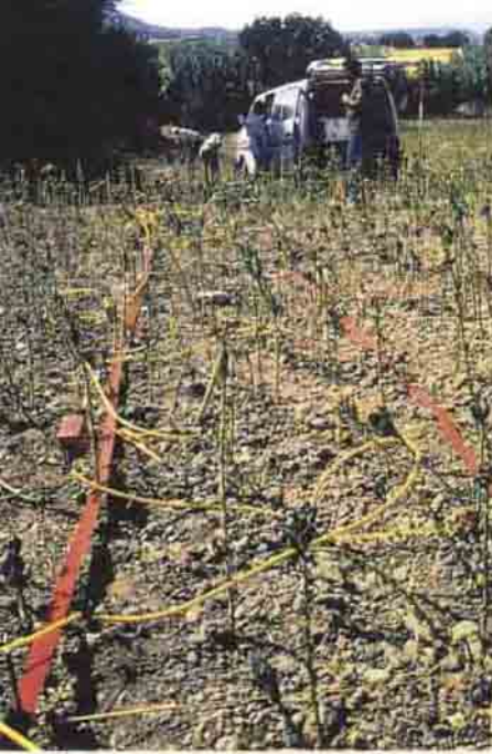
Çoklu elektrot dizgeli özdirenç ölçümü
