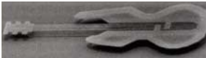
Telleri 100 silisyum atomu genişliğinde olan dünyanın en küçük gitarı, nanoteknoloji standartlarına göre dev bir yapı.
