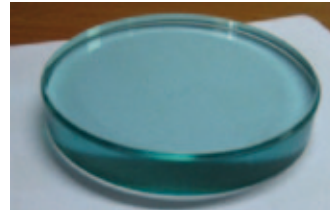
6 inç çapında ve 25 mm kalınlığında kenarları pahlınlanmış soda-kireç camı
