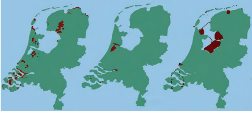
Şekil 5. 1860, 1900 ve 2000 yılları itibariyle Hollanda'nın deniz ve göllerinde fethettiği alanlar. 1860'lı yıllara kadar su ancak yel değirmenleriyle boşaltılabildiğinden kurutulan alanlar sınırlı kaldı. Ancak ileriki yıllarda buhar makinesinin yardımıyla daha alçak bölgeler de kurutulabildi. Günümüzde modern yöntemlerle hâlâ süren çalışmalar devasa boyutlardaki alanları karaya çeviriyor.
