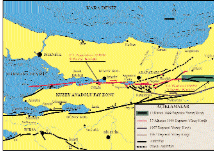
Şekil 1: Doğu Marmara bölgesinin aktif fayları ve 17 Ağustos 1999 Gölcük ve 12 Kasım 1999 Düzce depremlerinin yüzey kırıkları (Emre ve diğ. 1998'den değiştirilerek alınmıştır).
