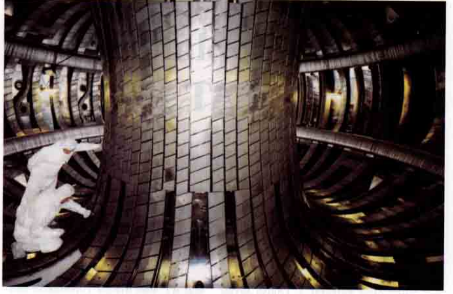
Termonükleer füzyon, yirmibirinci yüzyılın en önemli enerji kaynağı olmaya adaydır. Resimde, dünyanın en büyük deneysel füzyon makinesi olan JET (Joint European Torus)'in içi görülmektedir.
