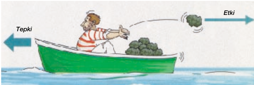
Etki-Tepki İlkesi: 1687'de Newton'ın ortaya attığı bu ilkeye göre bir roketin lülesinden aşağı doğru püskürtülen sıcak gazlar, roketin ters yönde bir tepki göstererek yukarı doğru ilerlemesine yol açar. Tıpkı iyi şişirilmiş bir balonun ağzı gevşetildiğinde içindeki gazları püskürterek yükselmesi ya da bir kayıktaki safraların geriye doğru atılmasıyla kayığın ters yönde ilerlemesi gibi.
