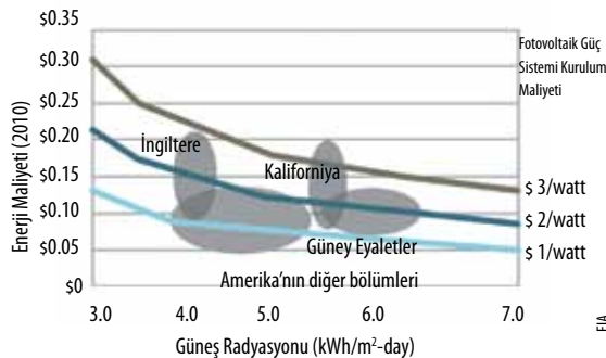
Şekil 4: Fotovoltaik güç sistemlerinin kurulum maliyetlerine göre, üretilecek elektrik enerjisi maliyetlerinin güneş radyasyonuna göre değişimi
