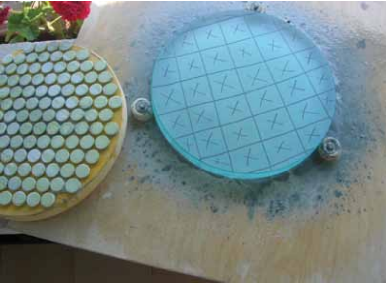
Fotoğraf 3: Burada anlatılan yöntemlerle yapılmış bir aşındırma aleti. Cam mozaikler epoksi ile alçı gövdeye yapıştırılmış.
