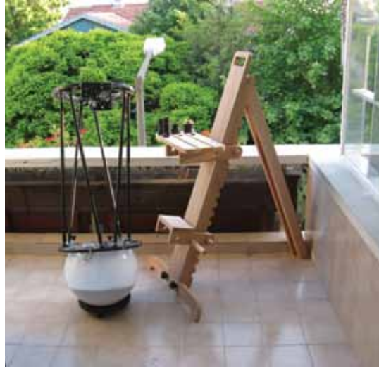
Küresel kundaklı 8" f/6 teleskop, ekvatoryal platform ve gözlem iskemlesi, Uludağ Tutyeli'nde 2200 metre yükseklikte yapılan bir gözlem sonrasında. (Solda)
