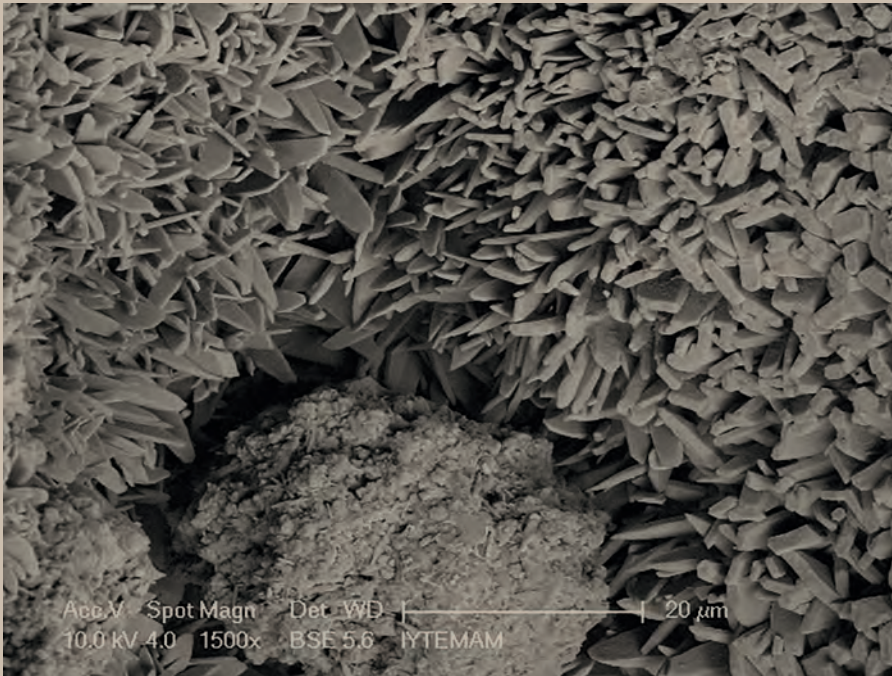
İznic Gölü kıyılarında 1200 yıl kadar önce oluşan yalıtışının taramalı elektron mikroskobuyla elde edilen görüntüsü. Bu görsel MS 715 depremi sonrasında göl seviyesinin hâlâ alçak olduğunu ve kurak koşullar altında taneleri birbirine aragonitlerin bağladığını belgeliyor.
