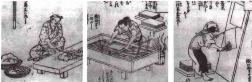
Daha sonra lifler ıslatılarak hamur haline getiriliyor ve büyük bir kazan içine konularak daha fazla su ekleniyordu. Ahşap çerçeveler bu kazana batırılıp, çıkarılıp, suyu süzdürülüyor ve elde edilen kâğıtlar kuruması için tek tek asılıyordu.
