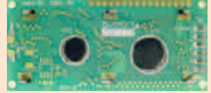
Şekil 4: LCD sürücü (arka görünüş)
