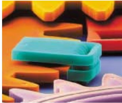
Birbirine kenetli bir mikromotor dişli sisteminin taramalı elektron mikroskopuyla elde edilmiş renkli görüntüsü. Bu tür çok küçük dişliler, yine çok küçük makine tasarımlarının ana öğeleri. Orijinal yapı, 200 kez büyütülerek, aslı 5,5 x 5,5 cm olan bu görüntü elde edilmiş.
