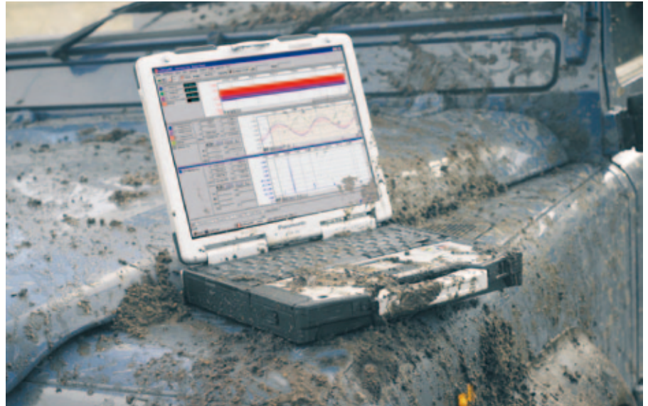
Bazı dizüstü bilgisayarlar zorlu dış koşullarla mücadele etmek üzere suya, çamura, sarsıntıya, aşırı sıcak ve soğuğa dayanıklı şekilde tasarlanıyorlar.
