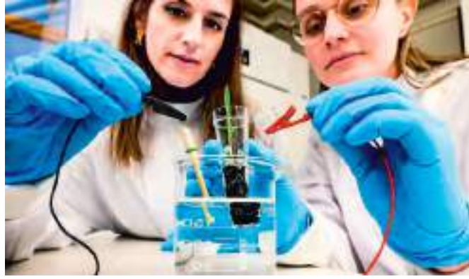
Eleni Stavrinidou ve doktora öğrencisi Alexandra Sandéhn, elektronik toprağı, bitki büyümesini teşvik etmek için düşük bir güç kaynağına bağlıyor. (Kaynak: THOR BALKHED)
