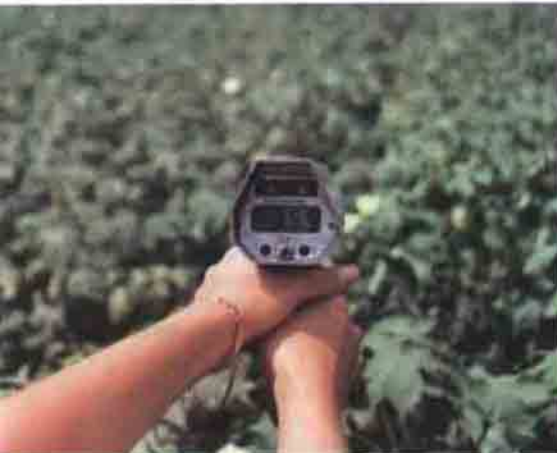
Infrared termometrenin tarlada kullanımı (üstte).
