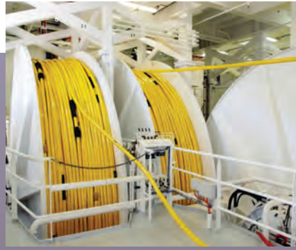
Şekil 5. Sismik gemilerde kullanılan alıcı kablolar.
