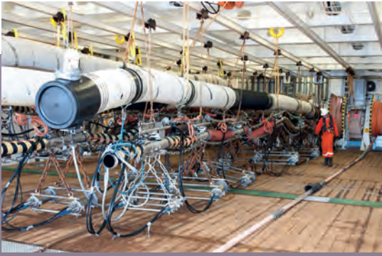
Şekil 4. Sismik sinyaller üretmek için, çok sayıda hava tabancası belirli bir düzen içerisinde birlikte kullanılır.
