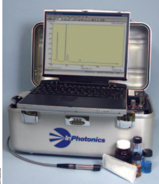
İçeriği bilinmeyen katı ve sıvı malzemenin kimyasal olarak ne olduğunu hızla çözen Mineral Teşhis Aleti (Mineral Identification Tool)
