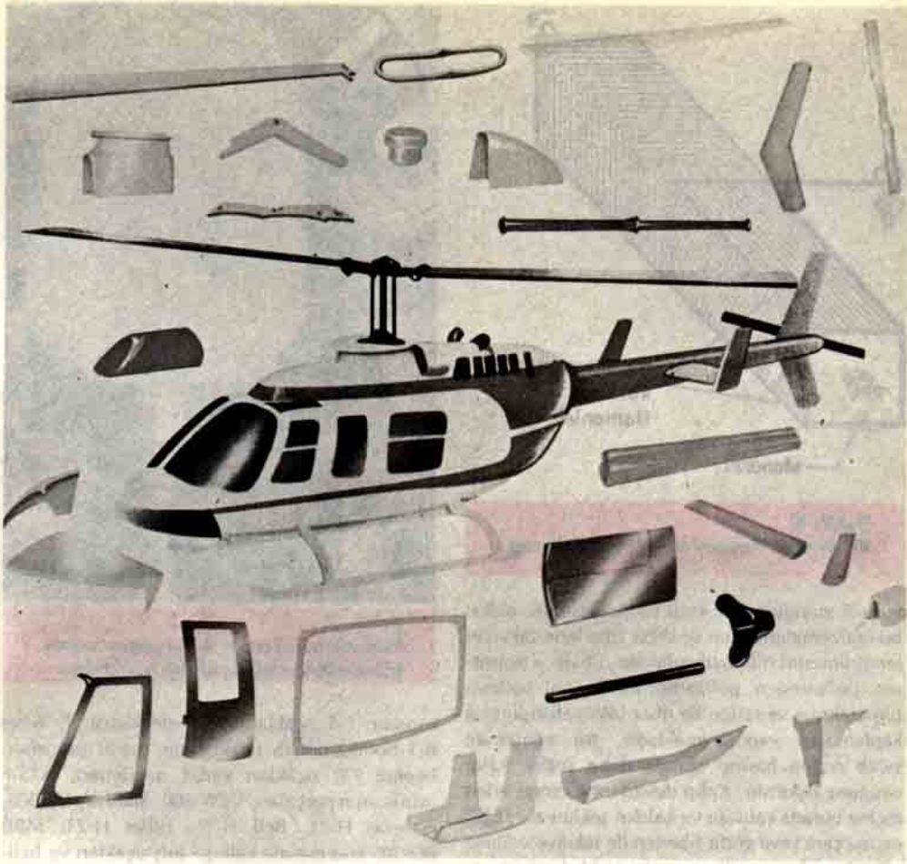
Deney olarak yapılan bütün parçaları kompozit malzemeden bir Helikopter.
